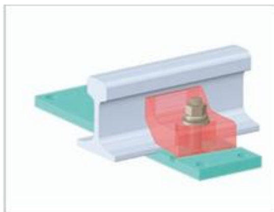
現行レールブレスのみの締結構造
